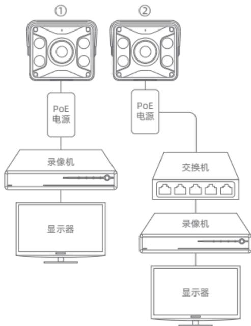
主流网络录像机支持IP搜索及修改IP功能，摄像机可通过图示方法连线后，直接在网络录像机中进行操作。
