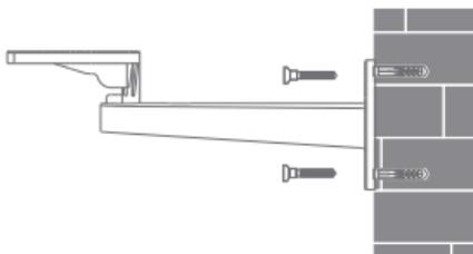
4. 将设备固定在壁装支架上，用螺钉锁死。
